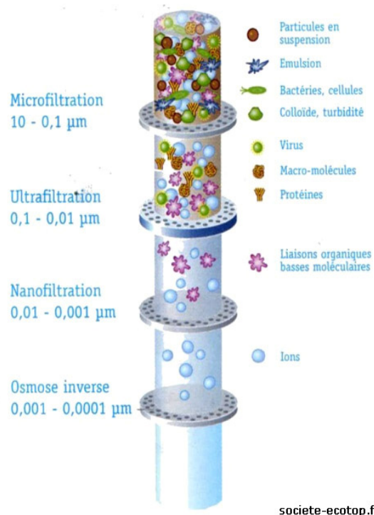
Figure 1: type de filtration à cartouche et efficacité.
