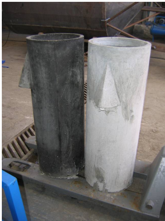
Figure 2 - Filtres à sable familiaux en béton, modèle de Pure Water for Haïti
