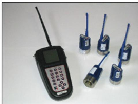
Figure 2 - Capteurs et enregistreur pour prélocalisation
